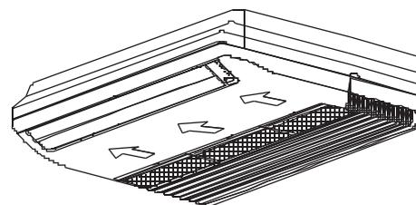
**!** При использовании пылесоса расположите фильтр стороной забора воздуха вверх. При прочистке фильтра водой расположите фильтр стороной забора воздуха вниз.
