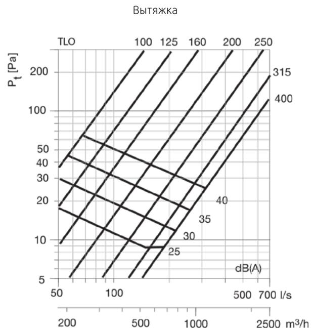
Аэродинамические характеристики диффузора TLO на приток с камерой статического давления
