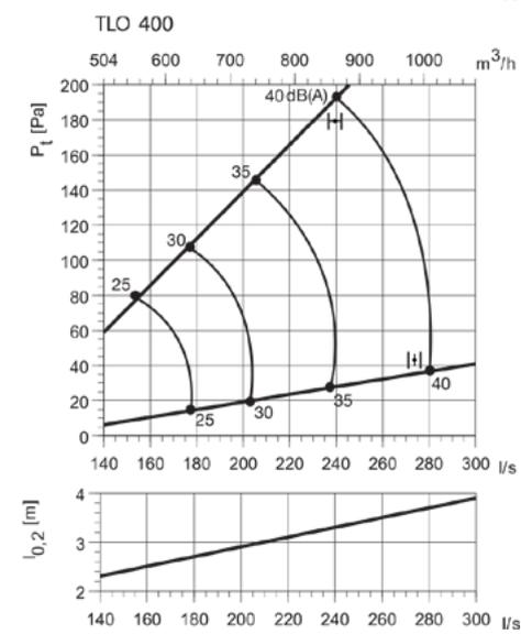
Аэродинамические характеристики диффузора TLO на вытяжку с камерой статического давления
