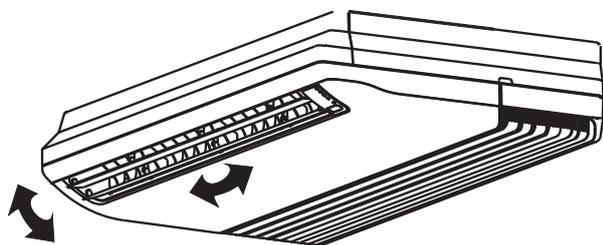
При работе на охлаждение – следует устанавливать воздушные заслонки горизонтально.
