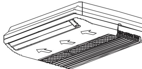
**!** При использовании пылесоса расположите фильтр стороной забора воздуха вверх. При прочистке фильтра водой расположите фильтр стороной забора воздуха вниз.
