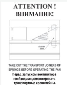
Предупреждающая табличка для подключения пружинного виброизолятора
